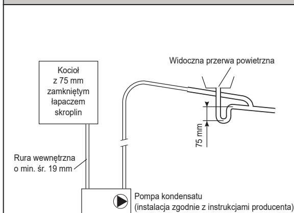
Rysunek 3 – połączenie pompy kondensatu typową metodą (zob. szczegółowe instrukcje producenta)
